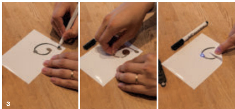
1. 左から杉本さん、清水さん、川原准教授 2. メディアの取材を受ける清水さん。新しい電気の体験を提供したい！と話す 3. 左から、マーカーで用紙に回路を描く→電池とLEDをセットする→線の一端を電池に接触させると！
